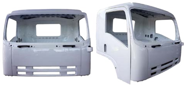
FM08-01-022-S1 โครงหัวถัง (โครงเปล่า)
