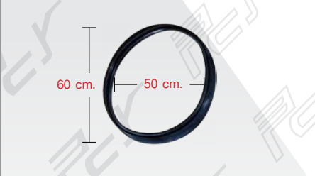
SHROUD SUB ASSY FAN RUBBER ยางบังลมหม้อน้ำ
